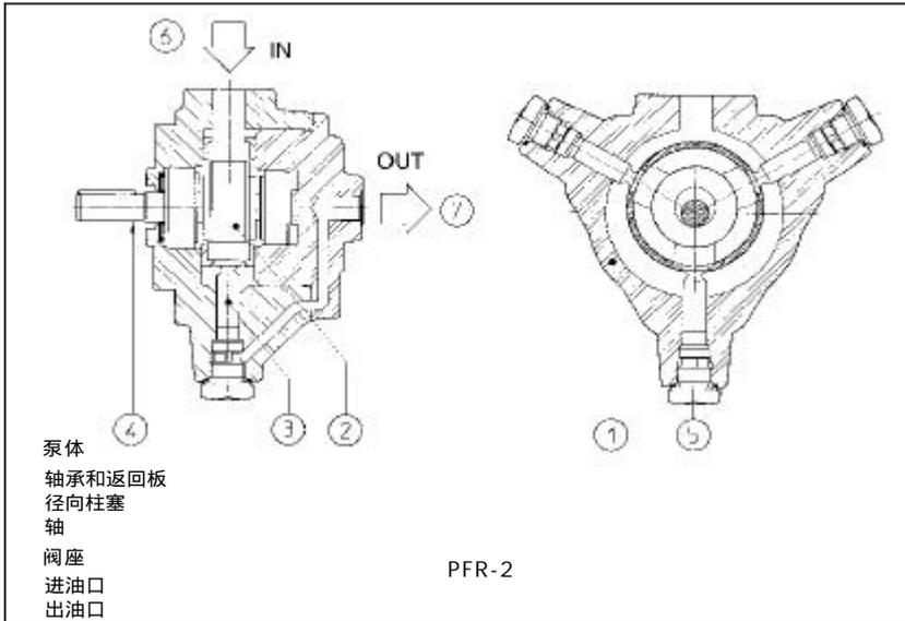
PFR是柱塞 正驱动结构定量径向柱塞泵,无返回弹簧,具有高性能、低噪音特性。
